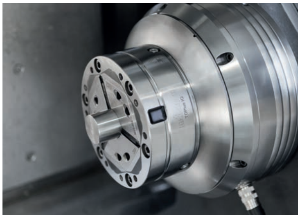
Spannfutter mit Kabel: Das TOPlus IQ ist ein intelligenter Datenlieferant für Industrie 4.0.
